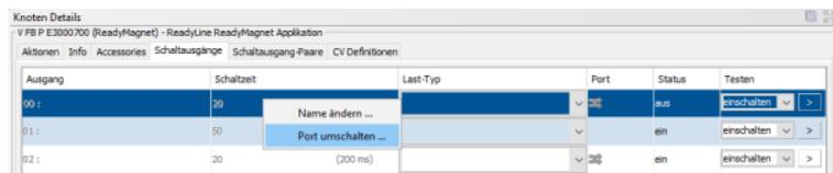
Im Auslieferungszustand ist die Baugruppe auf 4 Schaltausgang-Paare konfiguriert mit einer Schaltzeit von 200ms ohne Endlagenüberwachung. Im Fenster Schaltausgang-Paare können Sie diese Einstellungen verändern und Ihren Anforderungen anpassen.
