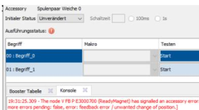
Schaltet ein Antrieb nicht korrekt, ist ein Verbraucher nicht mehr verbunden bzw. es wird ein Fehler erkannt - dann wird ein rotes Ausrufezeichen angezeigt und ein Fehler in der Konsole gemeldet.
