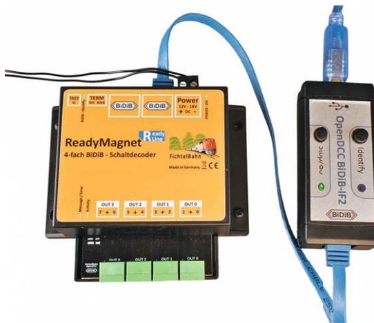
Schnell fertig: BiDiB-IF2 und ReadyMagnet von Fichtelbahn ergeben ein vollständiges System zum Schalten von Zubehör. Alle Fotos: Heiko Herholz
